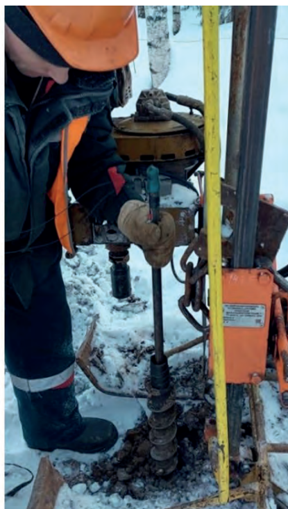
▼ Рис. 4. Процесс погружения сейсморужья в полый шнек.
