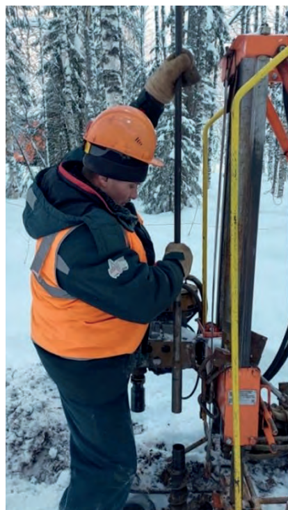
▼ Рис. 4. Процесс погружения сейсморужья в полый шнек.
