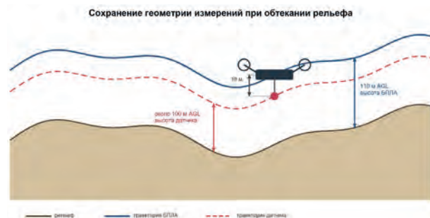
▲ Рис. 3. Принятая геометрия обтекания рельефа: высота носителя 110 м, длина подвеса 10 м, номинальная высота магнитометра около 100 м.
