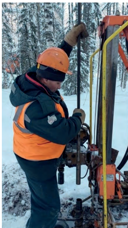
▼ Рис. 4. Процесс погружения сейсморужья в полый шнек.
