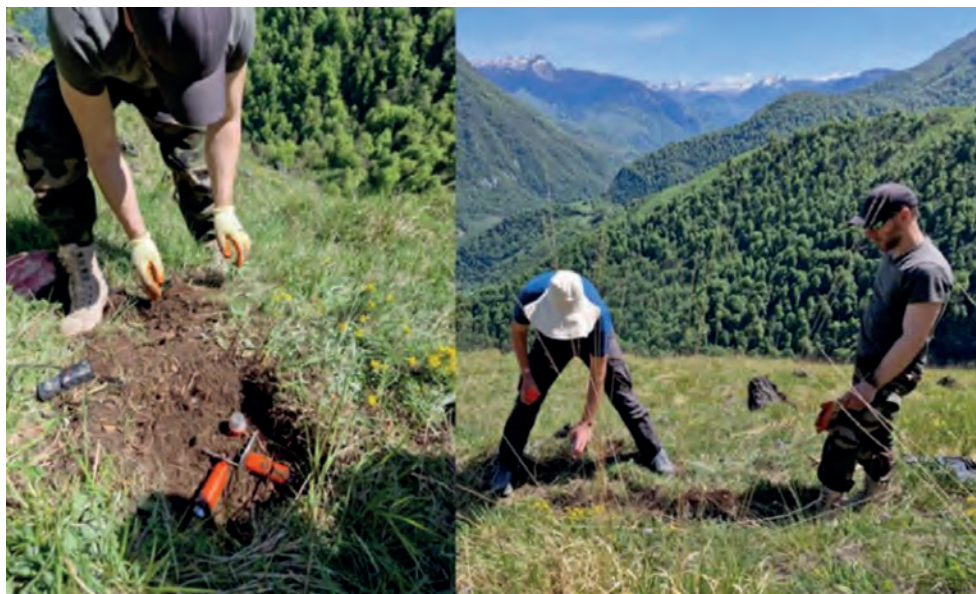
◀ Рис.5. Установка трехкомпонентных пунктов приема для длительного сейсмического мониторинга в Пиренеях.
