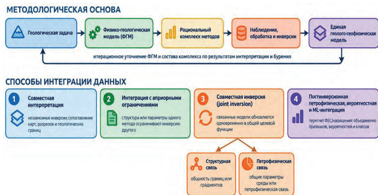
▼ Рис. 1. Методологическая основа комплексирования и основные способы интеграции геофизических данных
