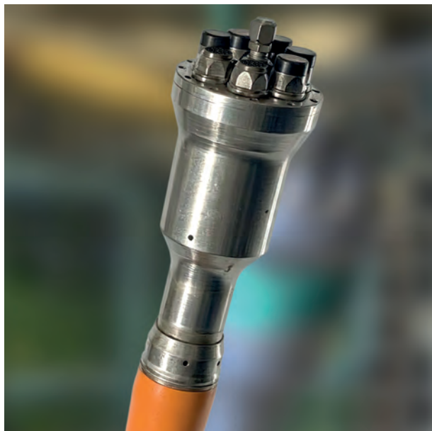
▲ Рис. 2. Мокрый конец амбликала. Общий вид.
