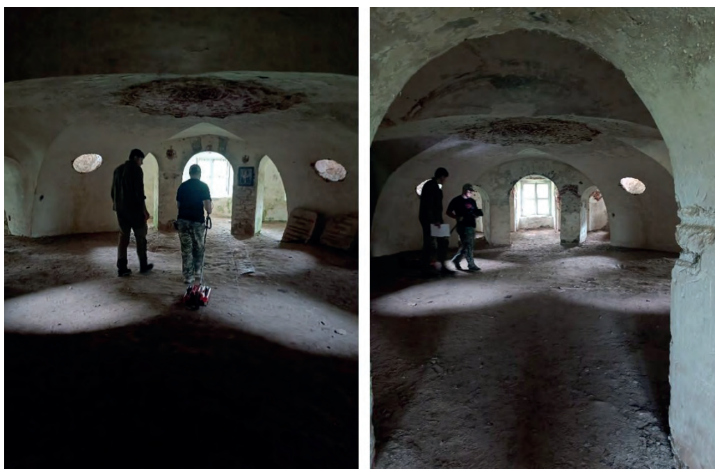
► Рис. 5. Георадарные исследования в нижнем храме
