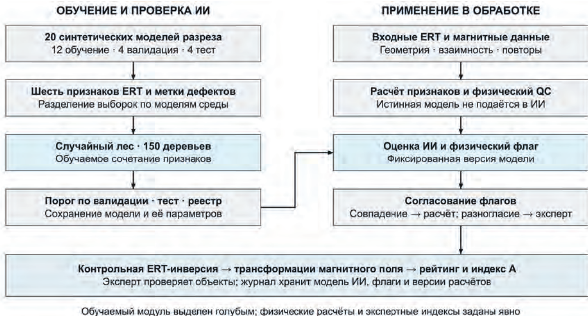
▲ Рис. 1. Последовательность обучения классификатора, контроля измерений и проверочной инверсии.
