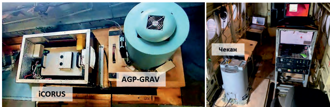
▼ Рис. 7. Сравнение нескольких мобильных гравиметров: бесплатформенного AGP-GRAV и iCORUS, а также платформенного Чекан-АМ.
