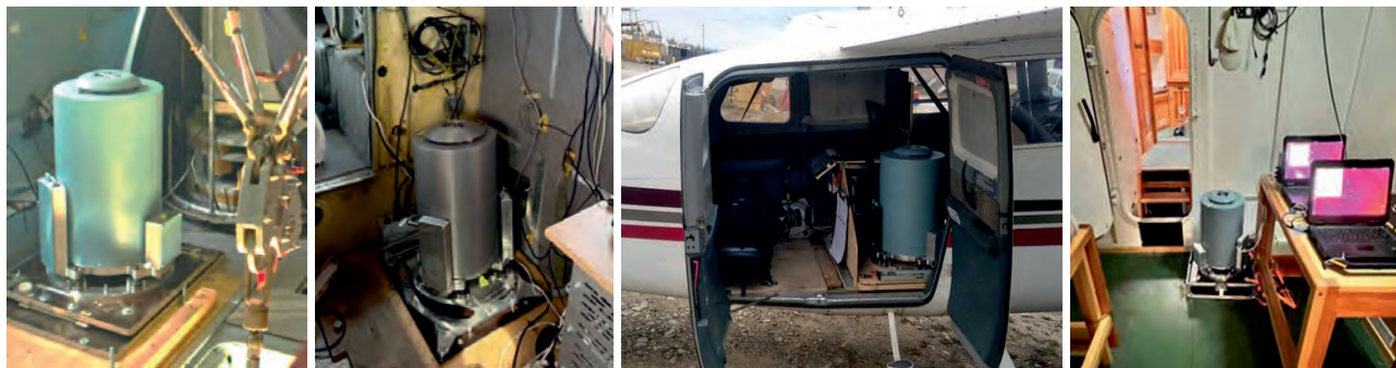
▲ Рис. 4. Мобильный гравиметр AGP-GRAV, установленный на разных носителях: вертолет Ми-8, самолет Ан-2, самолет Цесна-206, морское судно.
