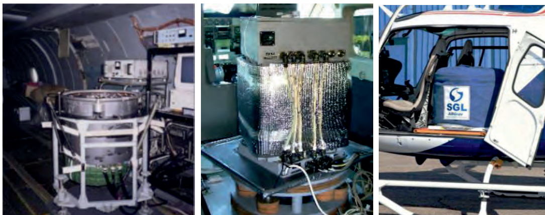
▼ Рис. 1. Примеры платформенных аэрогравиметров: ГРАВИТОН-М, GT-3A, AirGrav.
