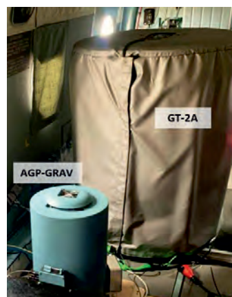
▲ Рис. 5. Сравнение мобильных гравиметров: бесплатформенного AGP-GRAV и платформенного GT-2A.
