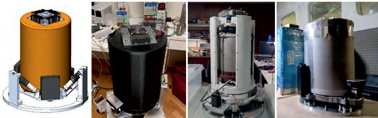
▲ Рис. 2. Разработка гравиметра AGP-GRAV: первая модель, лабораторные испытания, калибровка на стенде, испытания рабочего макета на самолете.
