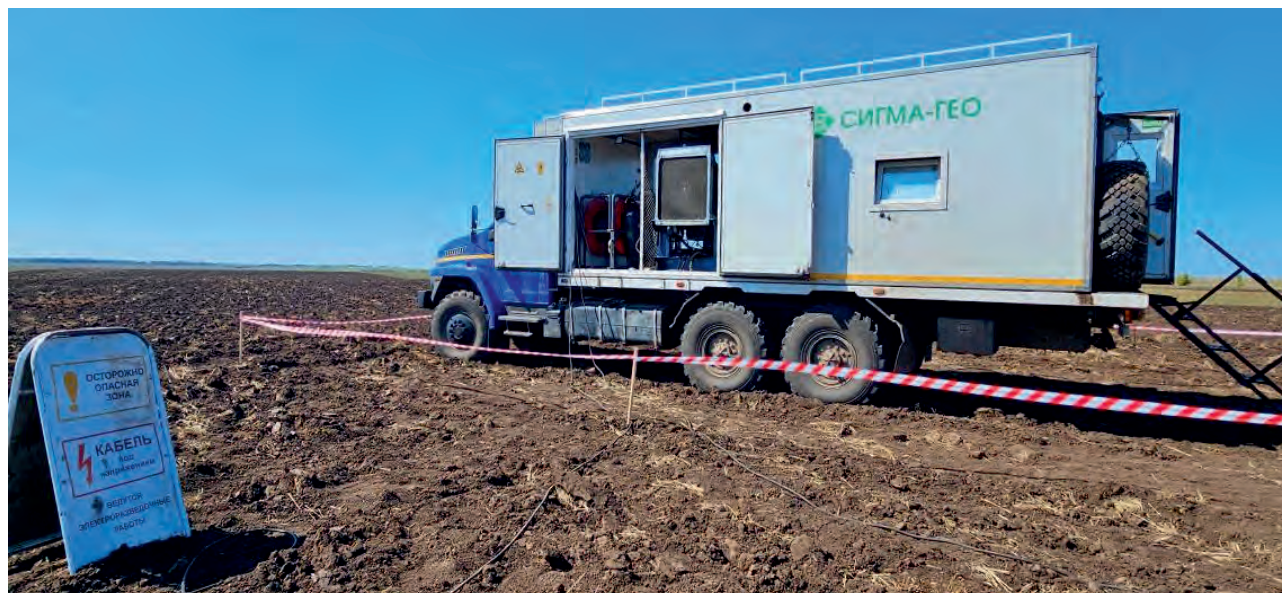
▲ Рис. 2. Мобильность и автономность. Мощная генераторная установка и смоточные агрегаты, интегрированные в автомобиль повышенной проходимости УРАЛ-NEXT.
