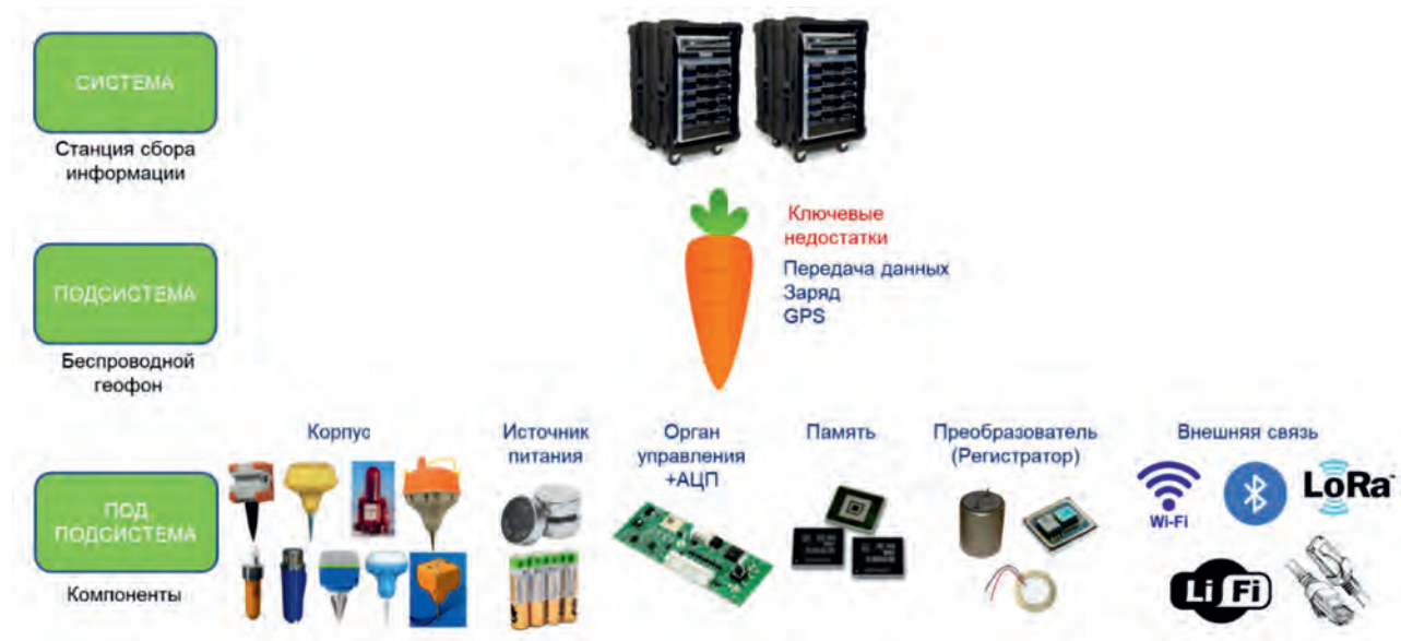
▲ Рис. 3. Системная вертикаль беспроводного регистратора.
