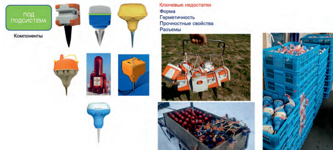
▼ Рис. 4. Недостатки формы при транспортировке и переноске беспроводного оборудования.
