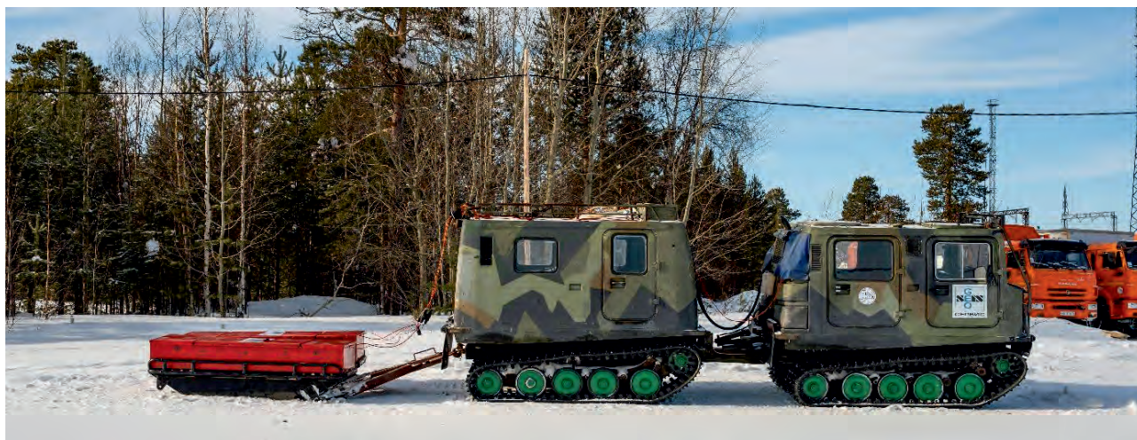
▲ Рис. 2. Малогабаритные импульсные источники «Геотон-70» повышенной мощности.
