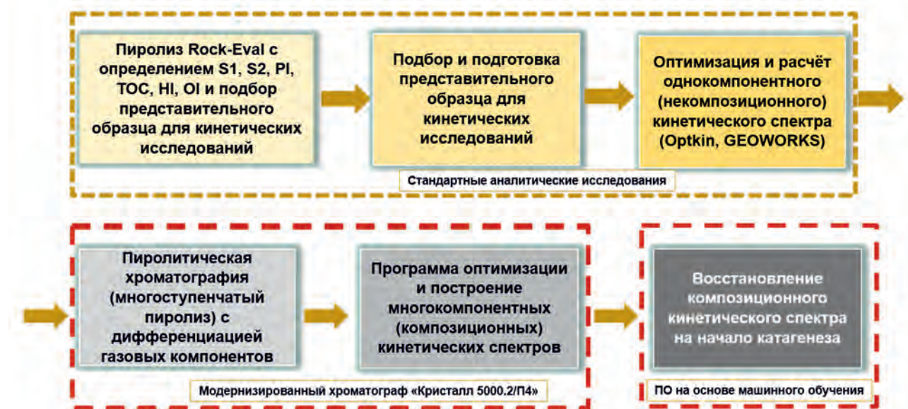
▲ Рис. 3. Схема реализации технологии GeoArrhenius.
