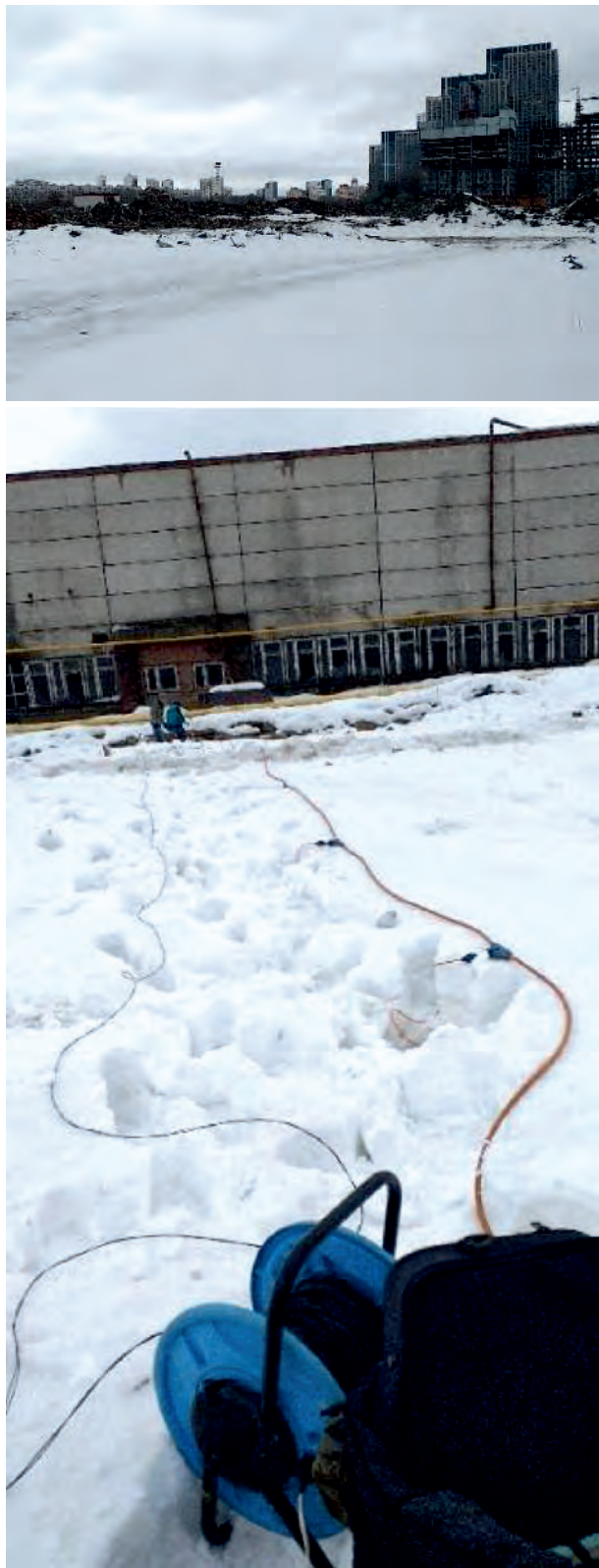
▲ Рис. 2. Выполнение наземной сейсморазведки в зимний период (Москва).
