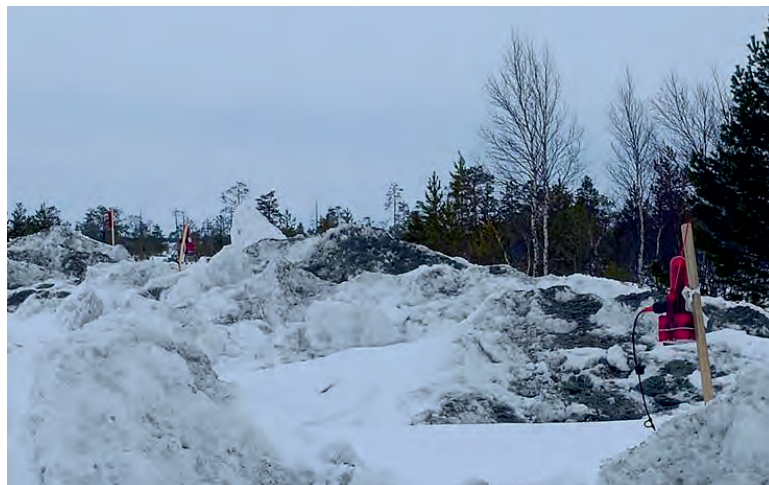
▲ Рис. 3. Поднятие блока ПАК «Геотом» увеличивает дальность и стабильность радиосвязи.
