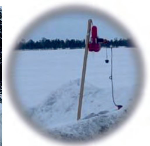
▲ Рис. 3. Поднятие блока ПАК «Геотом» увеличивает дальность и стабильность радиосвязи.
