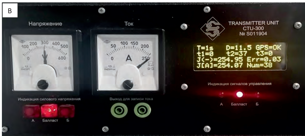
▲ Рис. 1. Состав аппаратуры SGS-TEM ПИКЕТ-32: А – измеритель, Б – рюкзак и цифровая линия связи на катушке, В – коммутатор тока CTU-300 с силой тока до 300 А.
