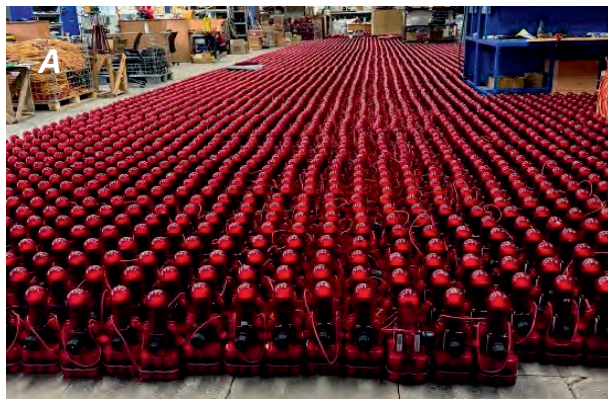
А - ПАК «Геотом» (Россия) - российская телеметрическая сейсморегистрирующая система.
