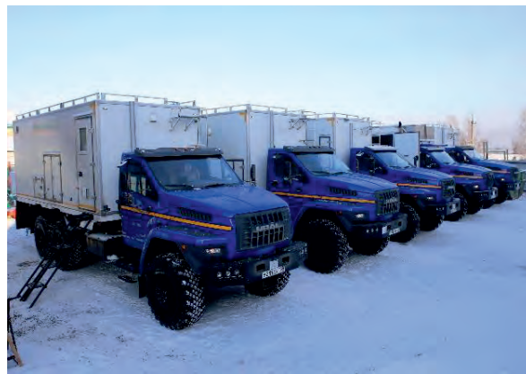
▲ Рис. 4. Применение современной техники для выполнения полевых работ – генераторная установка и смоточные агрегаты (слева) и колесная партия на базе автомобилей УРАЛ-Next (справа).
