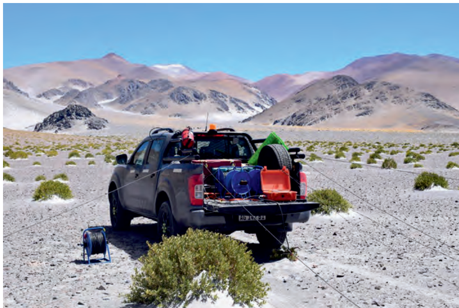
◀ Рис. 5. Электроразведочные работы с аппаратурой FASTSNAP в Южной Америке.
