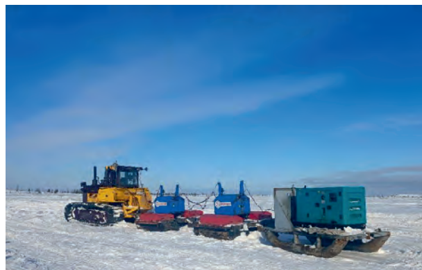
▲ Рис. 10. Группа импульсных источников ЭМИ в процессе подготовки к опытным работам.
