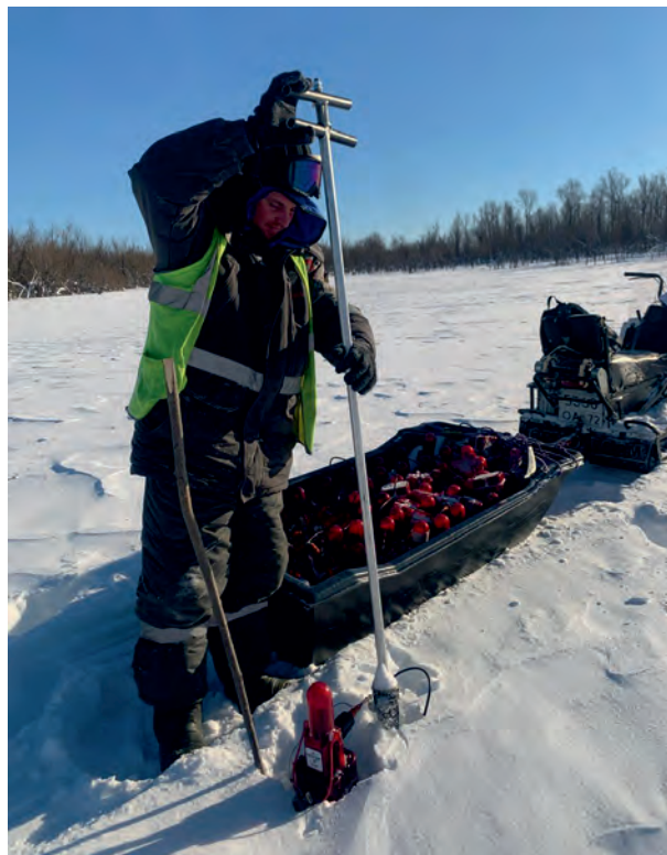
▲ Рис. 3. Использование погружателей сейсмоприемников обеспечило эффективную и надежную установку оборудования для регистрации.
