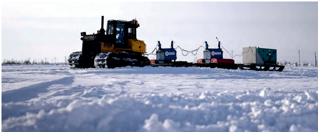
▲ Рис.5. Подготовка источников возбуждения перед началом опытных работ по высокоплотной сейсморазведке.
