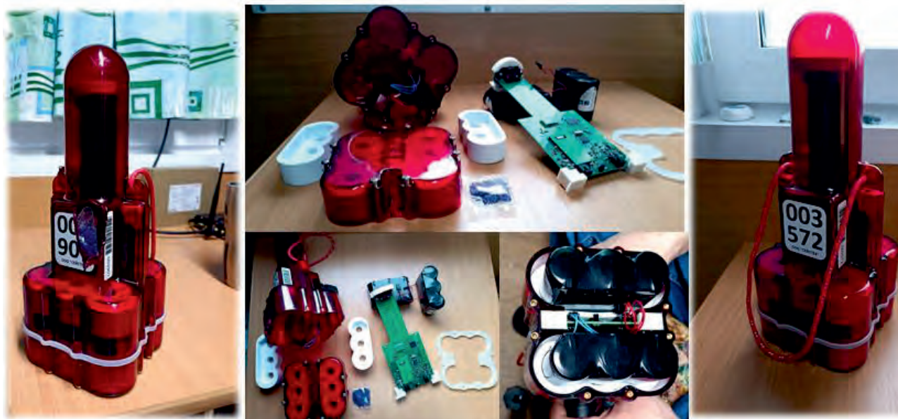
▲ Рис. 2. Корпуса блоков ПАК «Геотом» могут быть заменены в полевых условиях.
