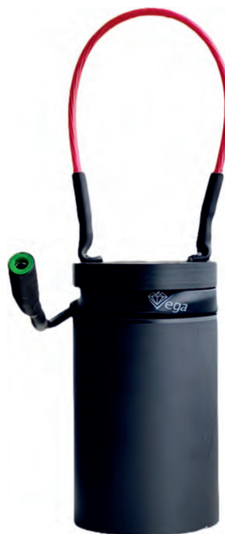
▲ Рис. 3. Внешний вид неполяризующегося электрода VNP.
