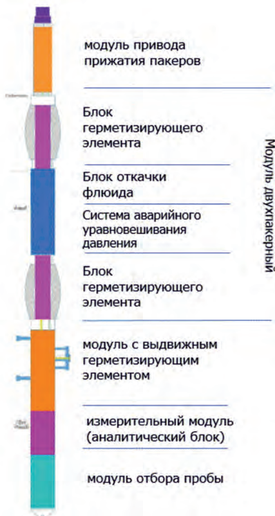
▼ Рис. 4. Блок-схема расположения модулей в приборе ДИП.
