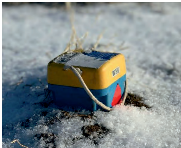
▲ Рис. 5. Нодальная система eSeis.
