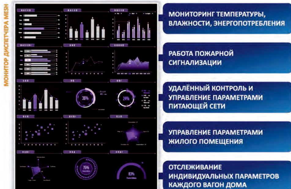
◀ Рис. 2. Интерфейс и возможности системы «Умный вагон-дом».
