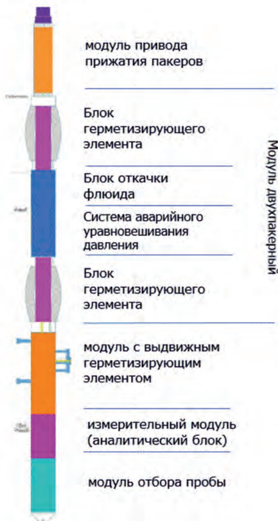
▼ Рис. 4. Блок-схема расположения модулей в приборе ДИП.
