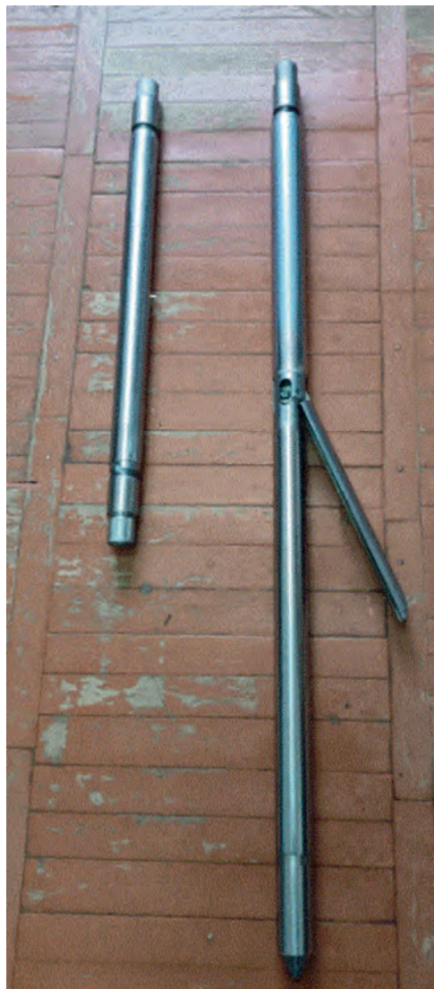
▲ Рис. 6. Модуль ГК (слева) и сейсмический модуль аппаратуры АСПУ-51МЦП.
