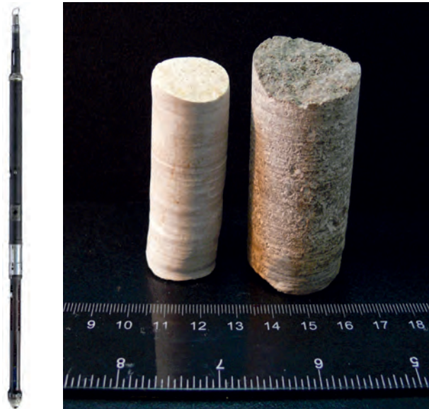
▲ Рис. 2. Сверлящий керноотборник СКТ-3М (слева) и образцы керна, отобранные приборами СКТ-3М и СКТ-3М-30 (справа).
