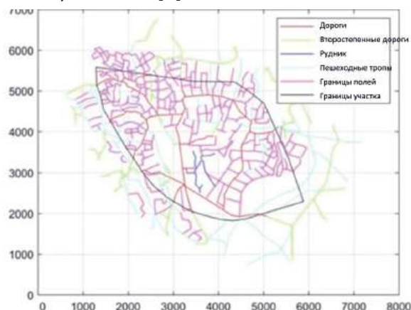
▼ Рис. 2. Результаты рекогносцировки площади исследования, показывающая различные возможные линии съемки, к которым был доступ, и границу области изображения. [1]
