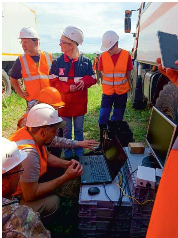
▼ Рис. 5. Управление и контроль ПАК «Геотом» может осуществляться с нескольких точек, непосредственно на профиле.
