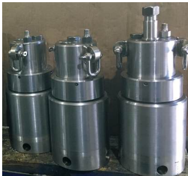
▼ Рис. 1. Пневматические излучатели «Малыш» для сейсморазведки в условиях мелководья.
