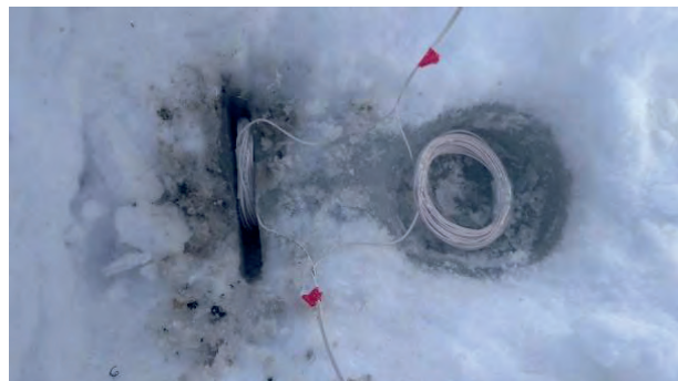
Рис. 7. Схема укладки волокна в двух перпендикулярных плоскостях.
