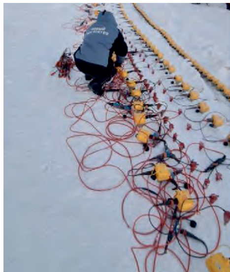
► Рис. 4. Проведение теста идентичности оборудования на базе сейсмо- партии.
