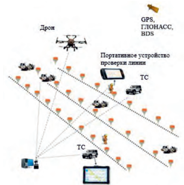
▲ Рис. 2. Схема развертывания системы Alwev в полевых условиях.
