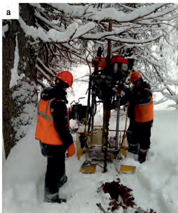
▼ Рис. 4. Процесс бурения взрывных скважин малогабаритной буровой установкой УБШМ 1-13 (а), патент на технологию экологосберегающей сейсморазведки (б).
