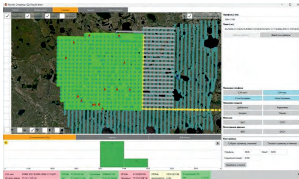
Рис. 6. Результаты теста «tilt – сопротивление» в процессе наладки на экране оператора ПАК «Геотом».
