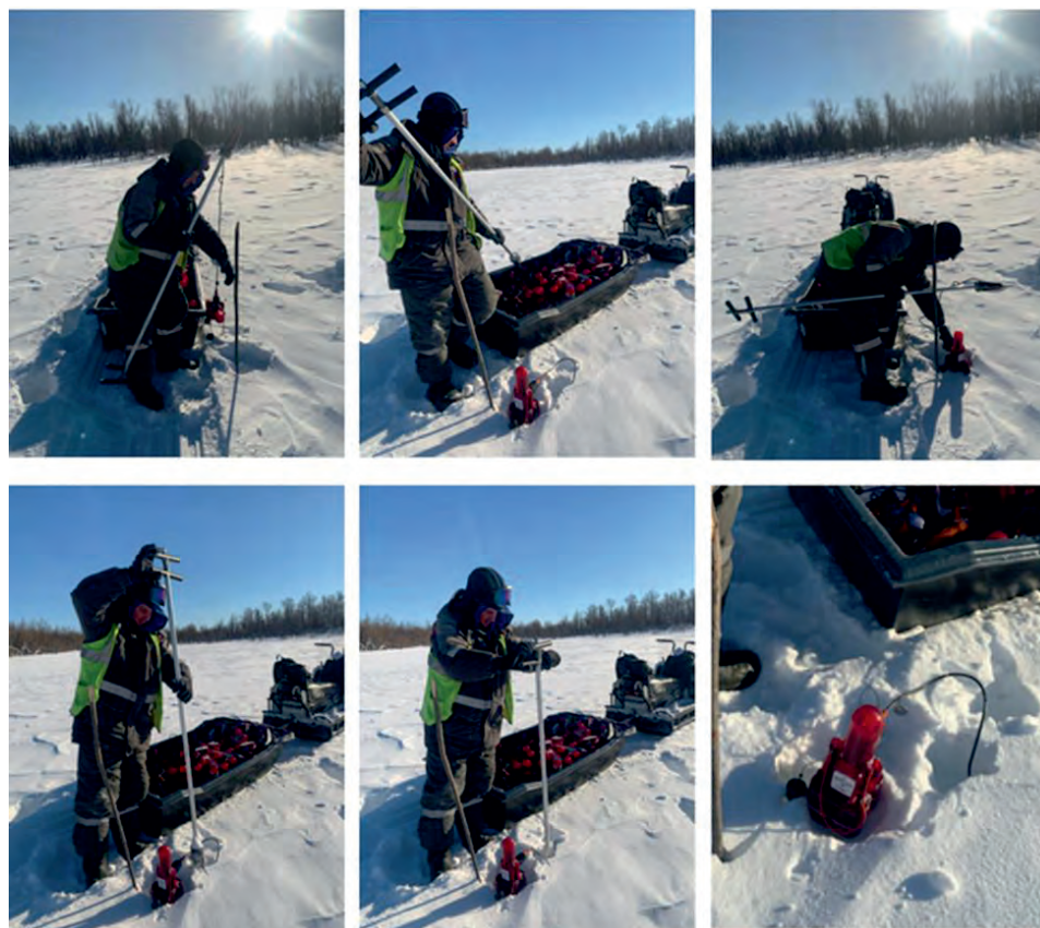
◀ Рис.7. Соблюдение технологии установки сейсмоприёмников минимизирует наладку оборудования.
