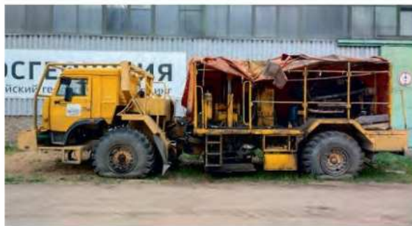
▼ Рис. 3. Фото сейсмических виброисточников СВ-30/150Б (М0) до ремонта и СВ-30Б-М1 (М1) перед отгрузкой заказчику.
