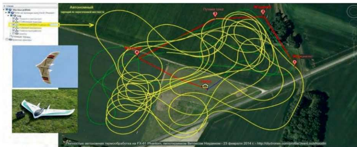
▲ Рис. 10. Пример полета с автономным GPS трекером, не включенным в систему управления, относительно плана полета. Реальная траектория- желтый цвет, полетное задание- красный, коррекция – зеленый.
