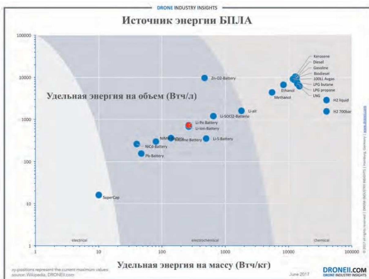
▲ Рис. 9. Источники энергии БПЛА – баланс и взаимная зависимость характеристик.
