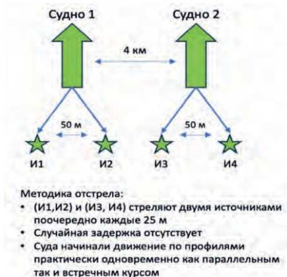
▲ Рис. 6. Конфигурация судов-источников, использованная на опытно-методических работах.
