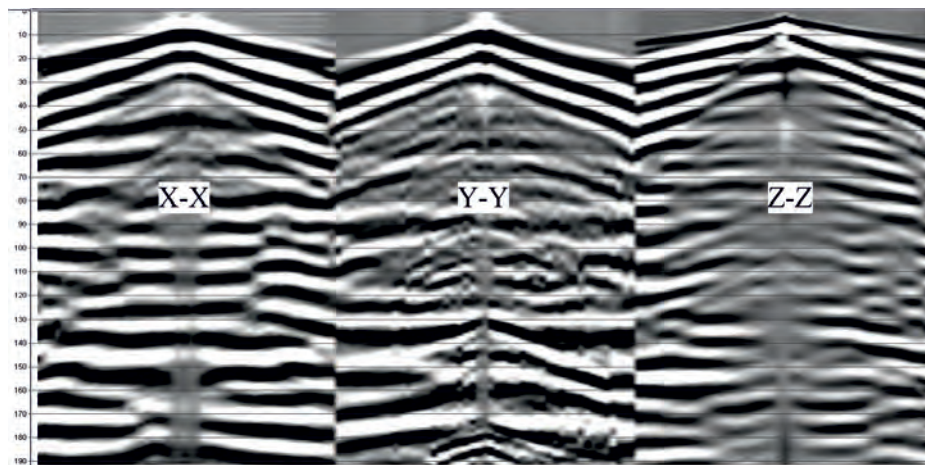
► Рис. 3. Супер-сейсмограммы по трём схемам наблюдений. По вертикали — время, мс; по горизонтали — удаление.
