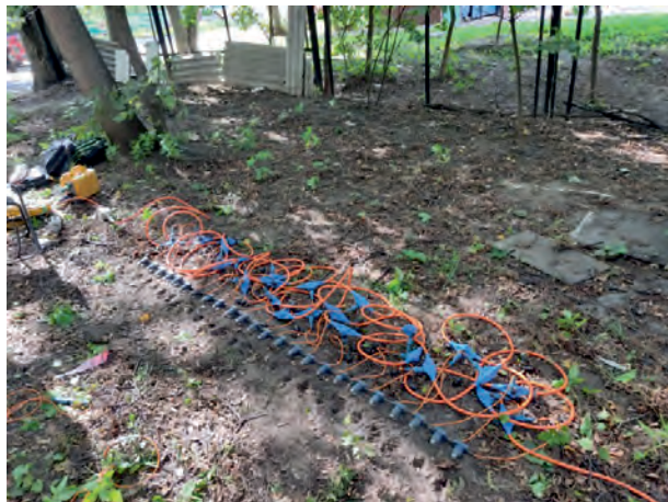
▲ Рис. 1. Приёмная линия с горизонтальными приёмниками (схема наблюдений Y-Y).
