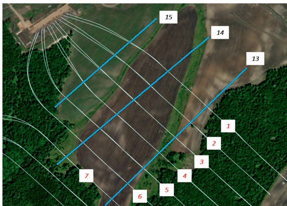
◀ Рис. 3. Схема взаимного расположения сейсмических профилей и пар горизонтальных скважин.
