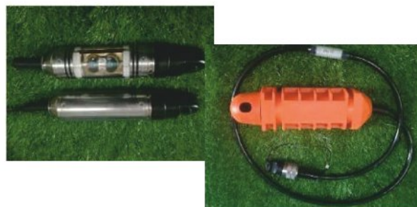
▲ Рис. 3. Гидрофон-геофон, поставляемый ООО «НОВЫЙ ВОСТОКГЕО».
