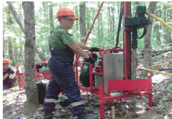
▲ Рис. 5. Мобильные буровые установки, использованные на горном проекте ТНГ-Групп.
