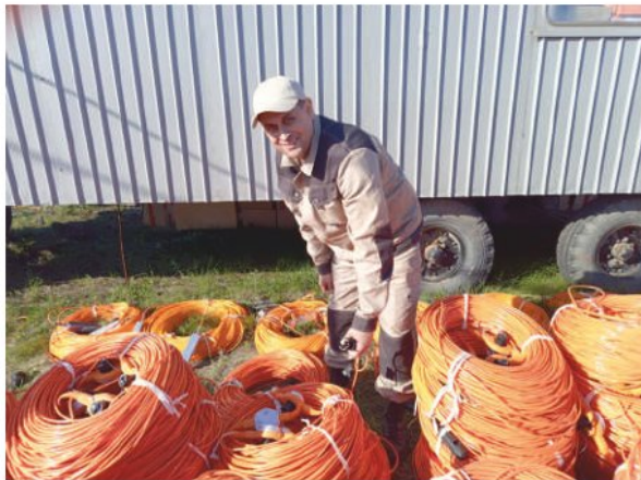
▲ Рис. 2. Оборудование «Сейсмосистемы СКАУТ-НТ» на площади испытаний.
