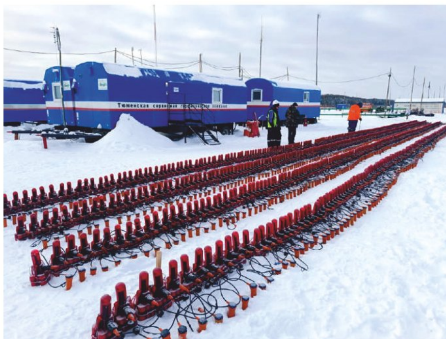
► Рис. 5. Тест на идентичность и подготовка блоков ПАК «Геотом» к расстановке.
