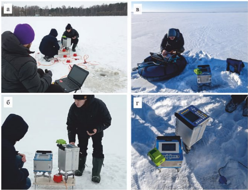
Рис. 2. Ход работ: а, б – 2023 г., оз. Сестрорецкий разлив; в, г – 2024 г., Финский залив. На фотографиях видны гравиметры Scintrex Autograv CG-5 и CG-6, GNSS приёмник Jawad Triumph 2, полевые модули ТЕЛСС-403, геофон РС-803. Сейсмостанция DAQlink-4 расположена на «ватрушке».
