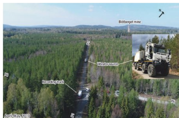
▼ Рис. 2. Вибрационные сейсмические исследования 3D в районе железорудной шахты в центральной части Швеции.
