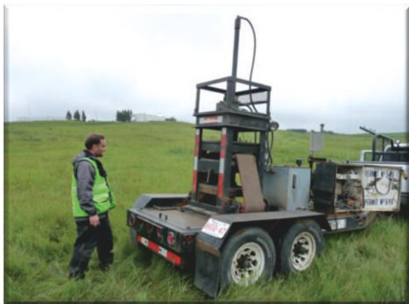
▲ Рис.3. Сейсмические работы в США (штат Иллинойс) для картирования крутопадающих магматических даек. Источник – ускоренный падающий груз весом 50 кг.
