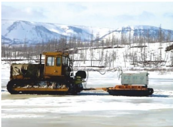
▲ Рис. 6. Работа буксируемого импульсного источника в движении на льду.
