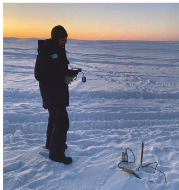
▼ Рис. 2. Нодальная система «GSX». Процесс проверки технических параметров ноды по радиоканалу.
