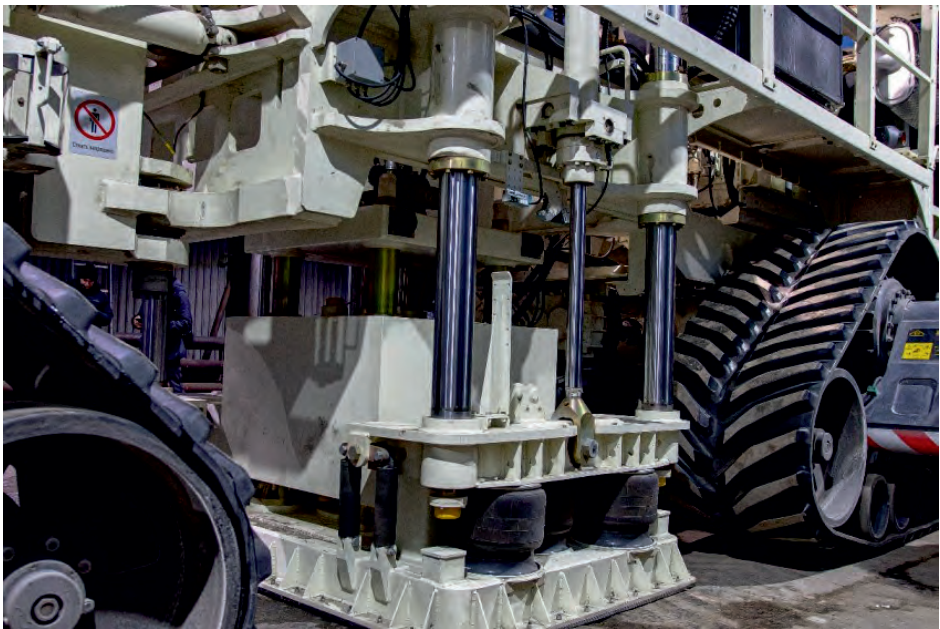
▼ Рис. 5. Расположение сервоклапана облегчает его обслуживание и ремонт.
