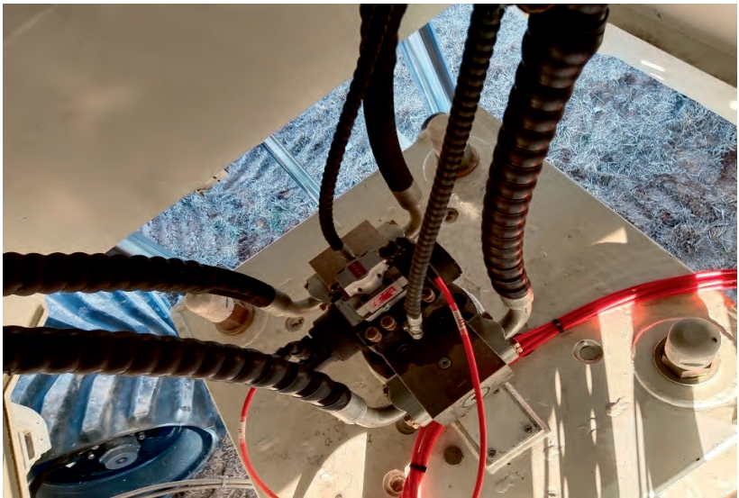
▼ Рис. 5. Расположение сервоклапана облегчает его обслуживание и ремонт.
