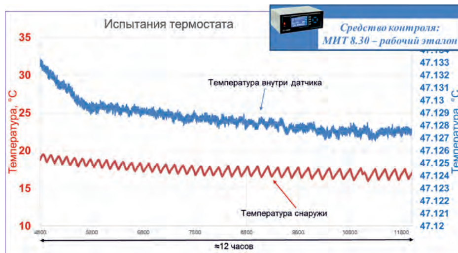
▲ Рис. 7. Результаты испытаний системы двухконтурного термостатирования гравиметра.
