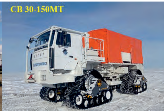
▲ Рис. 7. Модифицированная версия «БАТЫР» в колёсном и гусеничном вариантах.
