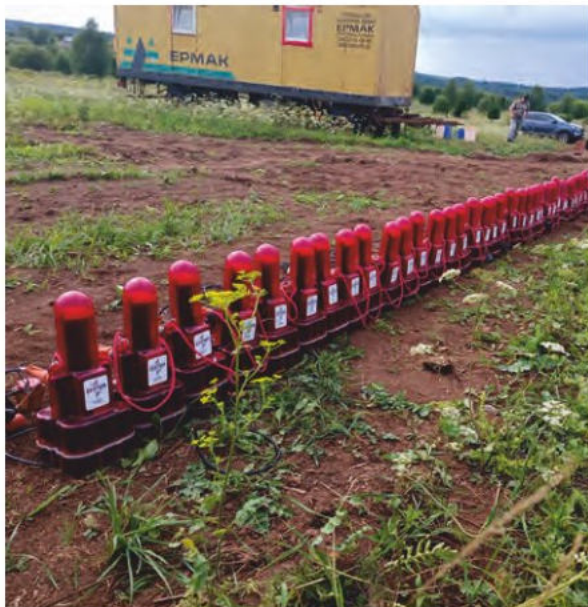
▲ Рис. 2. ПАО «Пермнефтегеофизика» готовится к тестированию бескабельной системы «Геотом», август 2023 г.
