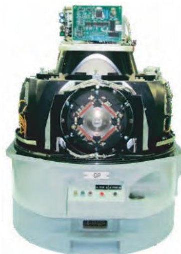
▼ Рис. 3. Морской набортный гравиметр «Чекан-АМ».
