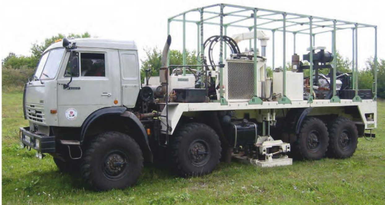
▲ Рис. 2. Виброисточник PLS-362 на шасси КАМАЗ.
