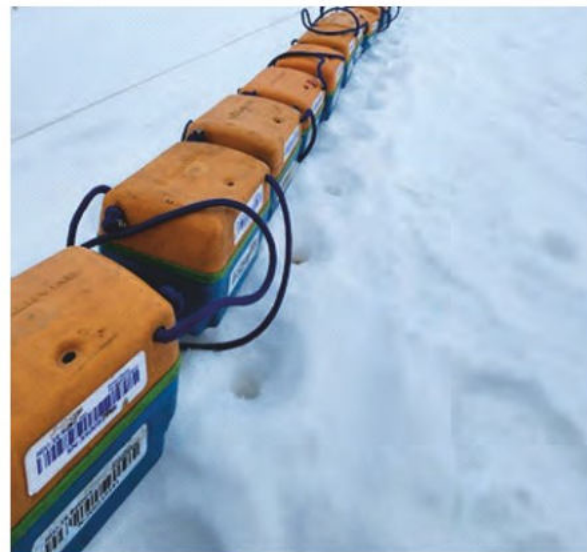
▲ Рис. 8. «Smart Solo» – надежный и простой модуль. Проверка оборудования перед началом работы.
