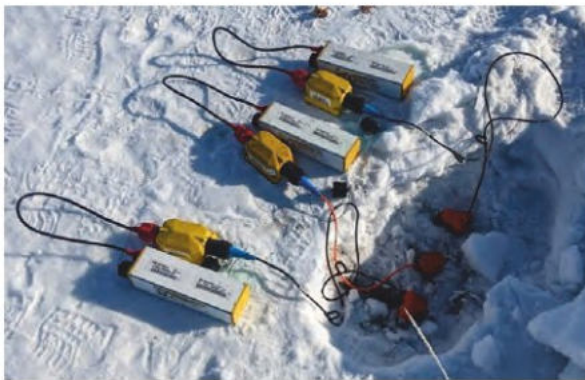
▲ Рис. 6. Бескабельная станция «GSX». Вариант организации ЗС регистрации, путем подключения разных приемников к нодам.
