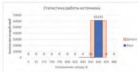
▲ Рис. 6. Статистика работы источников. Параметр — напряжение заряда. Обработка данных ОПР.
