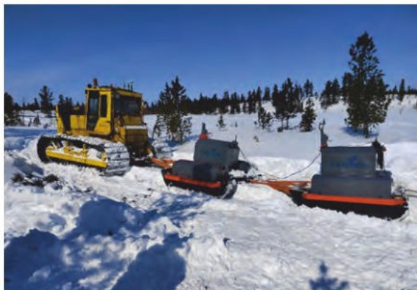
▲ Рис. 4. Работа импульсных источников «Абакан» на профиле.
