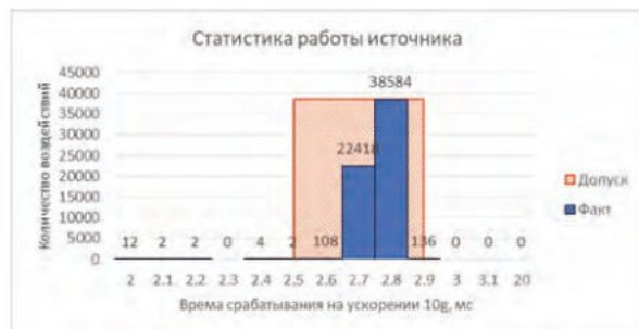
▲ Рис. 5. Статистика работы источников. Параметр — синхронность срабатывания.
