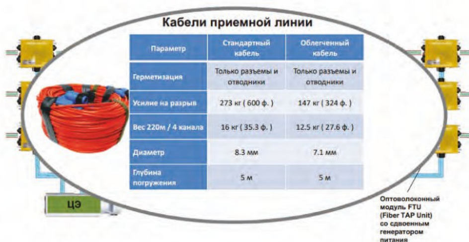
► Рис. 10. Кабельная система приемных линий имеет исполнение как в облегченном варианте, так и в стандартном исполнении.
