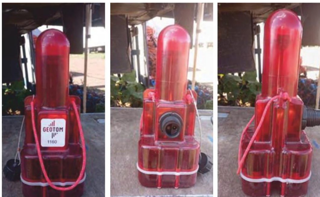
▼ Рис. 1. Полевой блок – главный элемент ПАК «Геотом».
