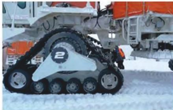
▲ Рис. 10. Арктическая подготовка виброисточника «ВОСТОК 62Т».
