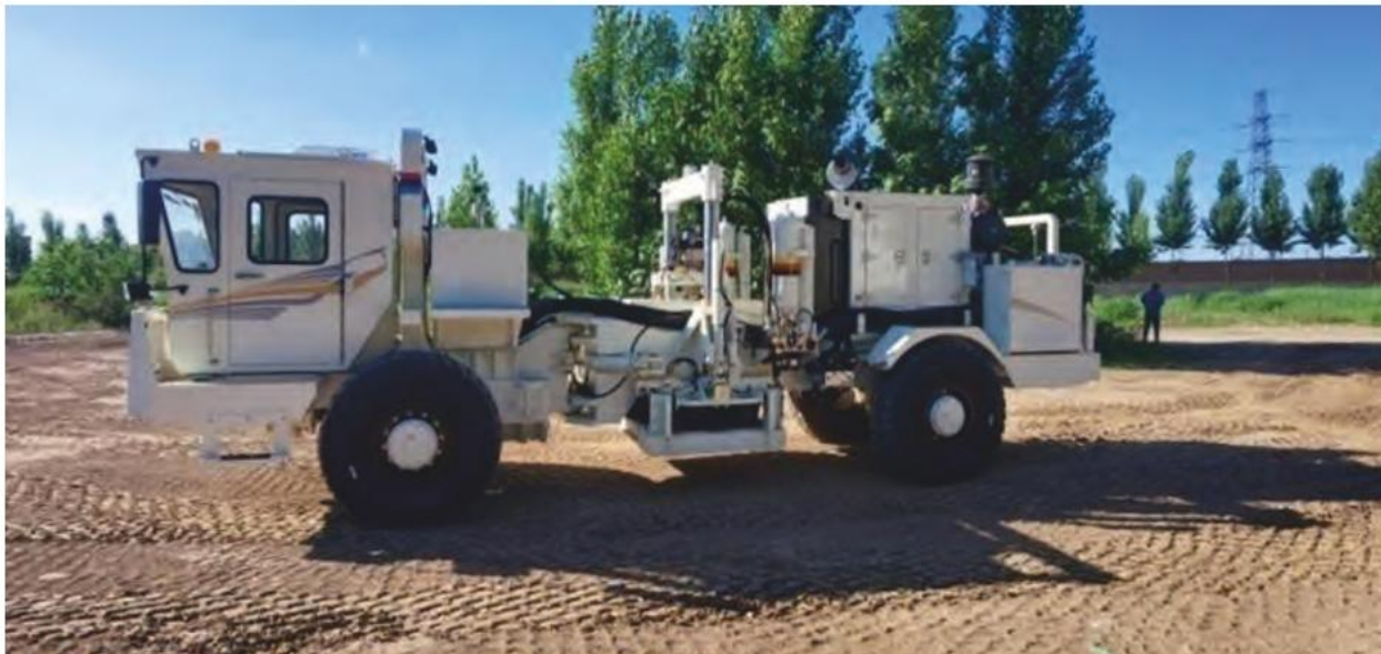
▲ Рис. 7. BV400 – маневренный источник для работы в лесах мощностью 19 тонн.
