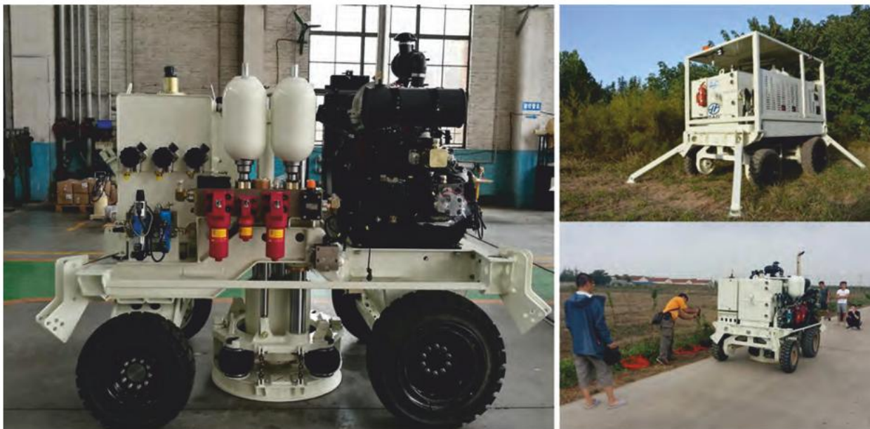
▲ Рис. 4. BV-400LF – источник мощностью 2 тонны для решения инженерных задач.
