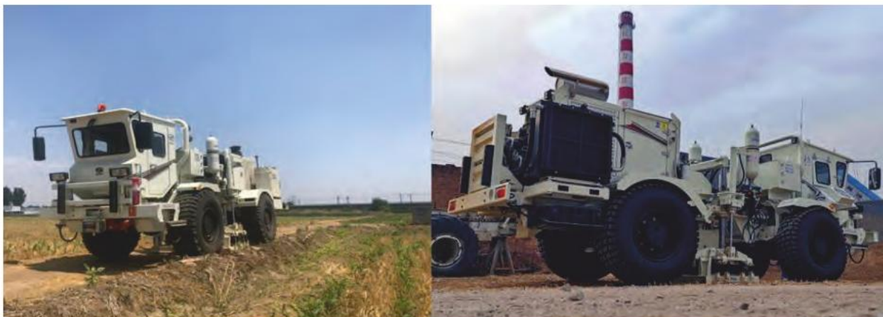
▲ Рис. 8 – BV270 - источник мощностью 12 тонн для сейсмозазведки средней и малой глубины в городах, деревнях, на сельскохозяйственных угодьях.
