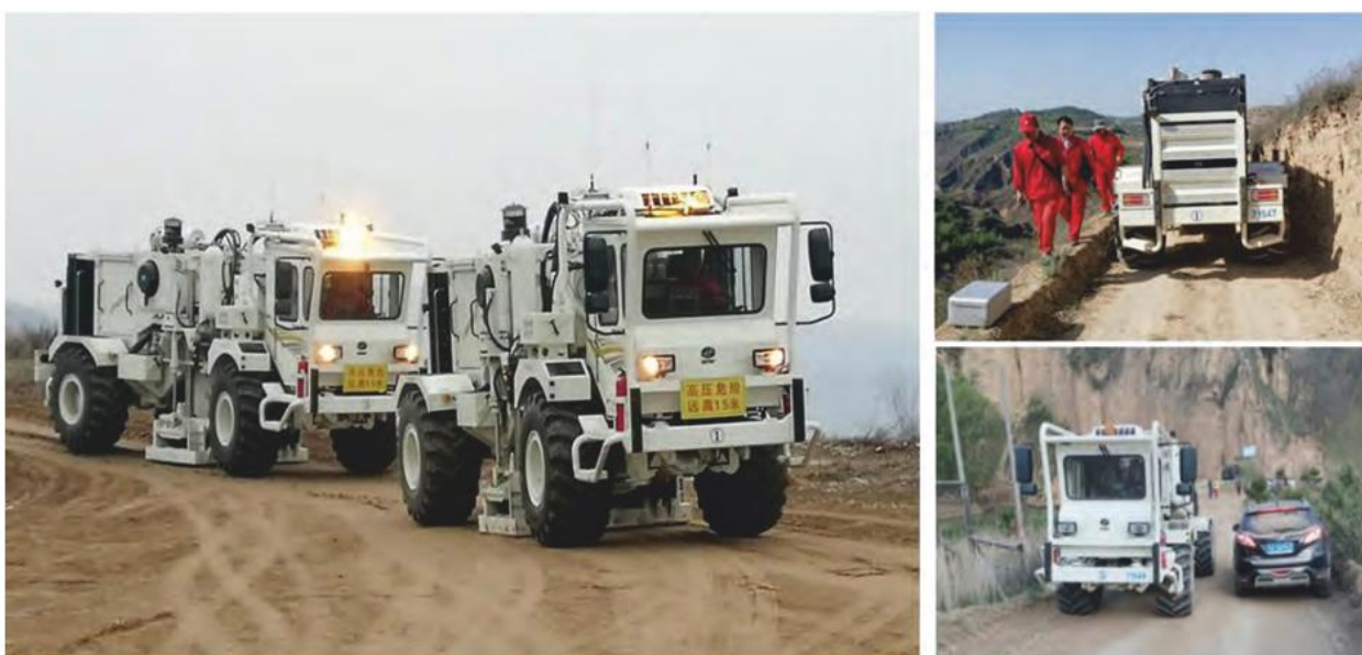
▲ Рис.6. BV330CQ – маневренный источник мощностью 15 тонн для работ в горных или городских условиях.
