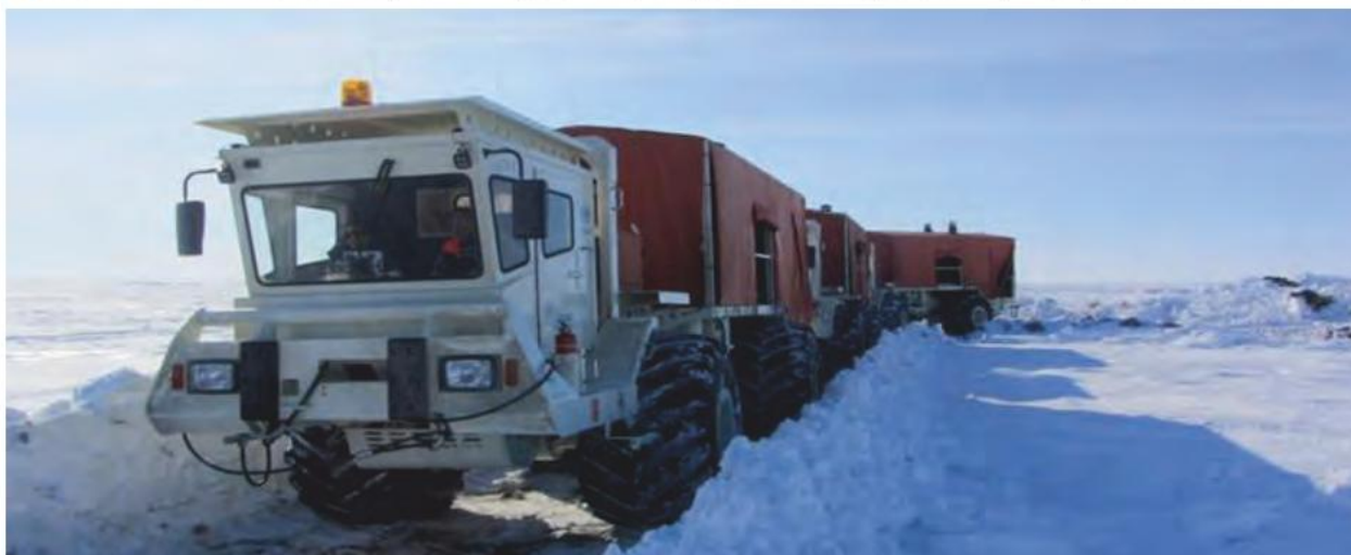
▼ Рис. 3. BV-300S – источник мощностью 14 тонн с возможностью возбуждения продольных волн.
