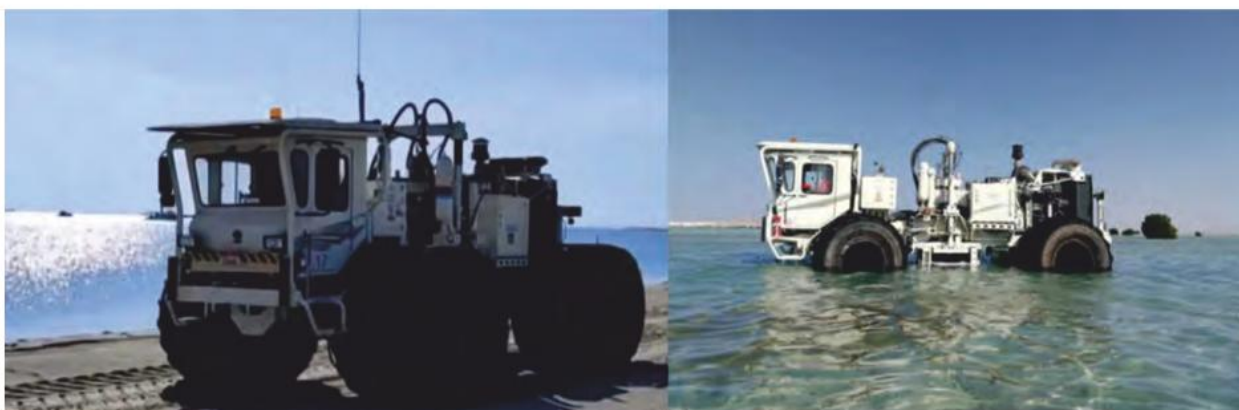
▲ Рис. 5. BV-330ZZ – источник мощностью 15 тонн для работ в переходных зонах и на сорах.
