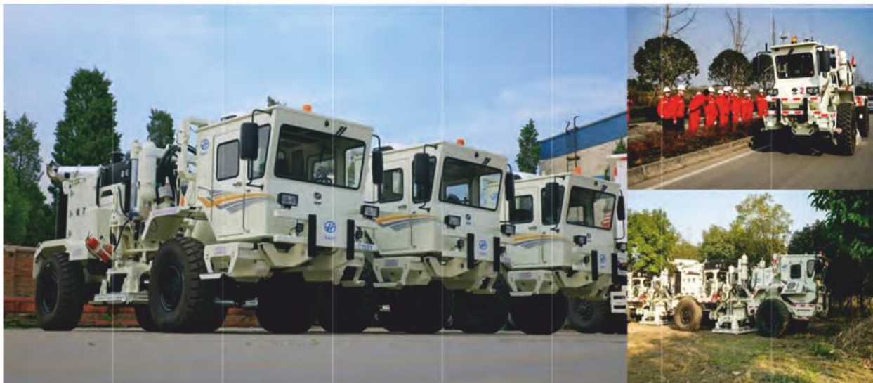
▲ Рис. 9 – BV500 – универсальный источник мощностью 23 тонны.
