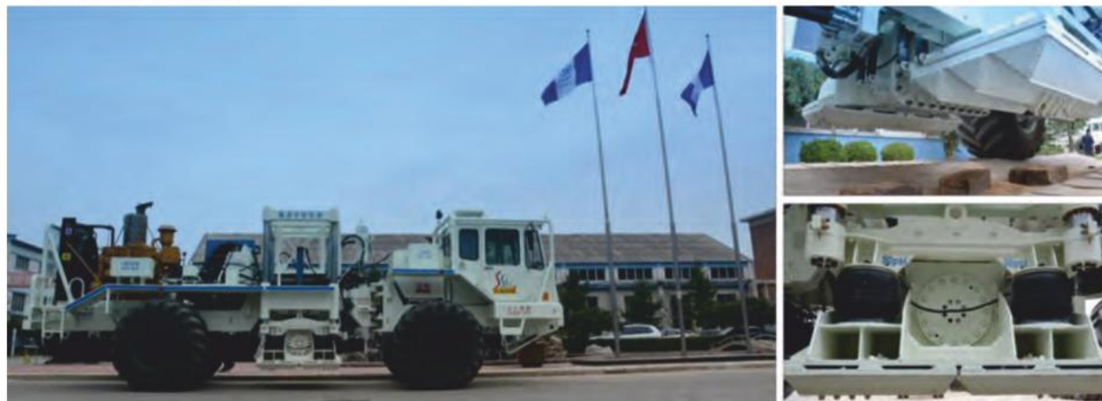
▼ Рис. 3. BV-300S – источник мощностью 14 тонн с возможностью возбуждения продольных волн.
