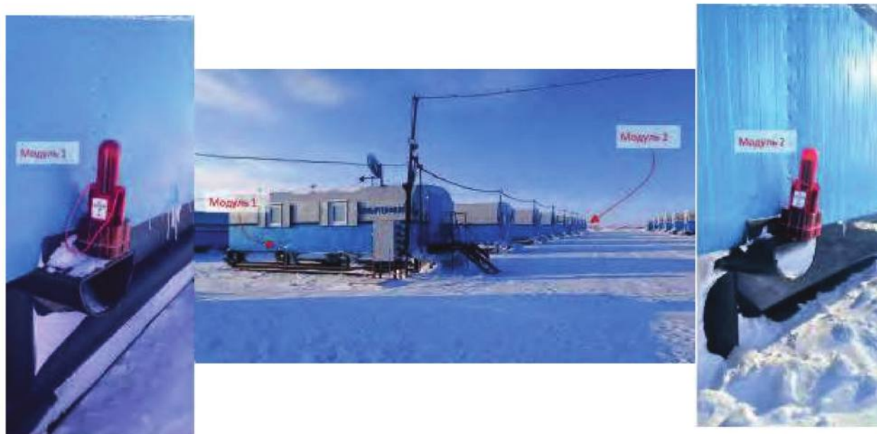
▲ Рис. 5. Оценка влияния инфраструктуры партии на радиосигнал между блоками Геотом.
