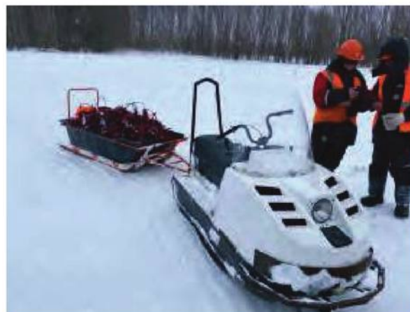
▲ Рис. 2. ХМАО. Бригада приступает к размотке – в санях 100 блоков Геотом с одиночными сейсмоприемниками.
