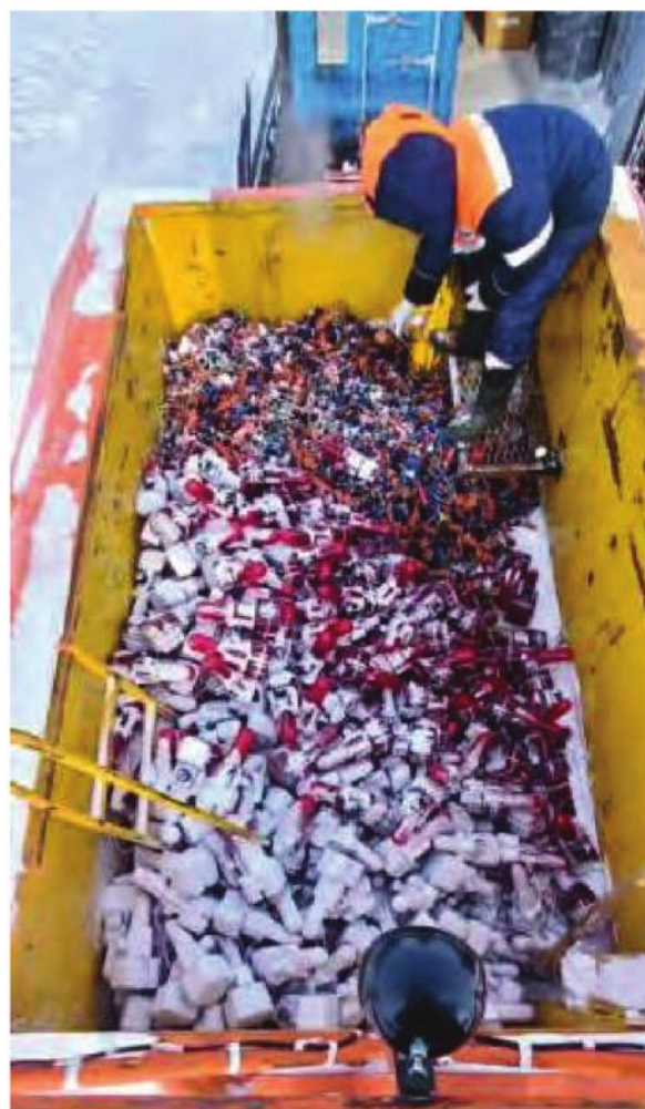
▲ Рис. 3. Заполярье. На борту 491 канал Геотом с группами сейсмоприемников.
